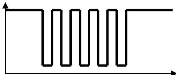
• **Несовпадение ID карты (брелка) со списком карты (брелка), записанных в устройство** – после подключения карты светодиод вспышкает 1 раз, на выход 1 подается 1 короткий импульс. После этого устройство возвращается в режим ожидания карты (брелка) – то есть светодиод горит постоянно, а на выходе 1 устанавливается высокий уровень. Пример импульса на выходе приведен на графике ниже.
