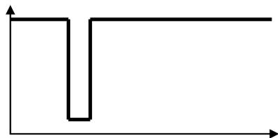
• **Отказ в заправке. Причина: не передан отчет о предыдущей заправке в БК «АвтоГРАФ»** – светодиод вспышкает 2 раза, на выход 1 подается 2 коротких импульса. После этого устройство возвращается в режим ожидания карты (брелка) – то есть светодиод горит постоянно, а на выходе 1 устанавливается высокий уровень. Пример импульсов на выходе приведен на графике ниже.
