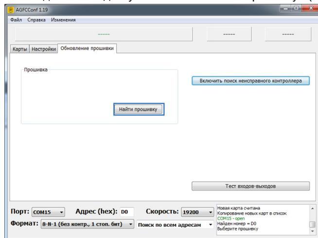
Рис.24. Выбор прошивки для загрузки в неисправный контроллер.
