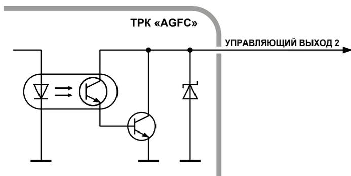
При прикладывании к передней панели ТПК «AGFC» или установки в картоприемник карточки водителя на управляющий выход 2 подается сигнал на включение насоса – сигнал низкого уровня (логического «0»).
